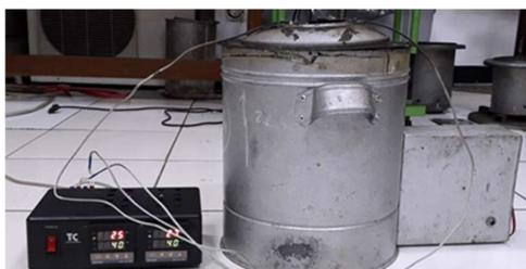
**Gambar 2** Rangkaian alat pengujian laju dan lama pembakaran briket
